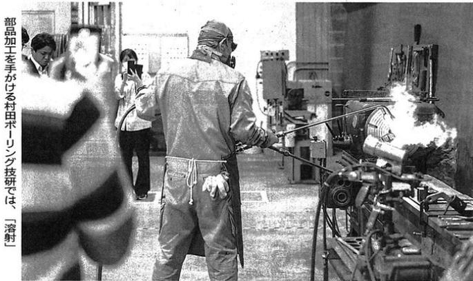
部品加工を手がける村田ポリリング技研では「溶射」
