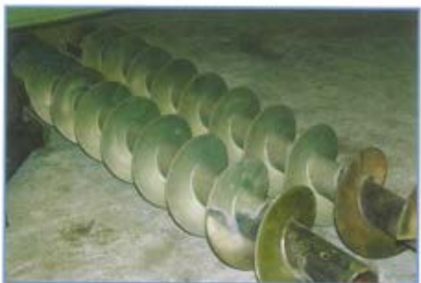
搬送用スクリーコンベア 粉末式フレイム溶射(耐食・耐摩耗)
