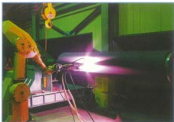
フレキシソ印刷用ロール プラズマセラミック溶射(耐摩耗)
