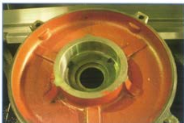
モーターカバー・ブラケット再生溶射 溶線式フレーム溶射
