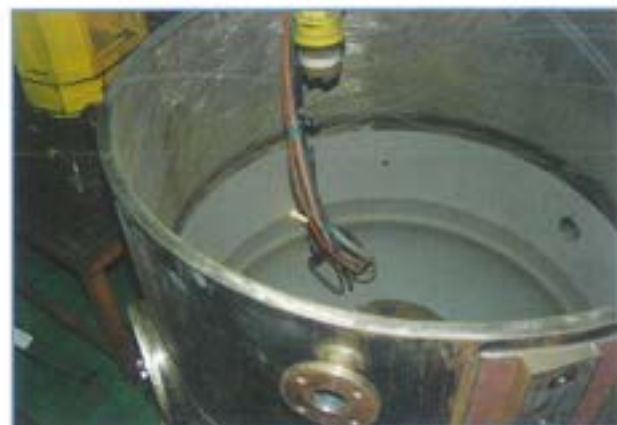
粉体機械用タンク内面 HVOFサーメット溶射(耐摩耗)
