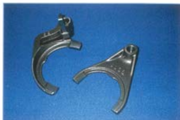
シフトフォーク 耐摩耗モリブデン溶射
