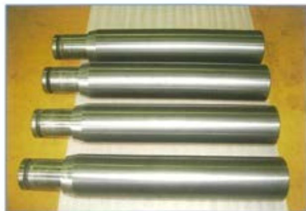
高圧ポンププランジャー HVOFサーメット溶射
