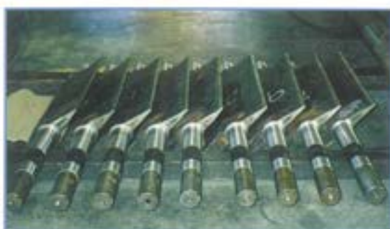
水力発電所向ガイドベーン 軸受部再生溶射 溶線式フレーム溶射(ステンレス鋼)
