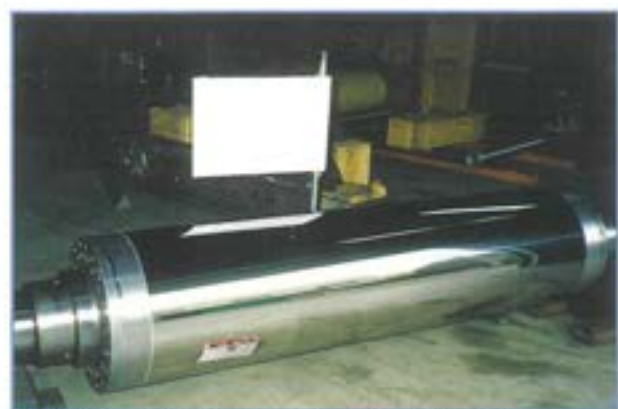
製紙機械用ワインダーロール(φ500×3740L) HVOFサーメット溶射(耐摩耗)～鏡面仕上
