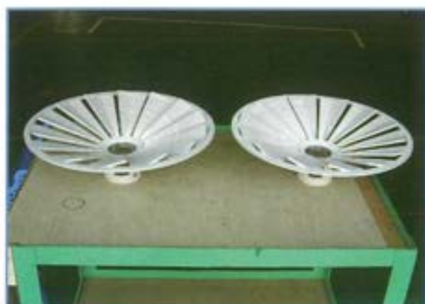
冷却ファン 耐熱:プラズマ溶射
