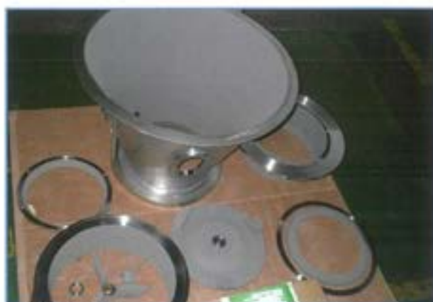
粉砕機械部品 HVOFサーメット溶射
