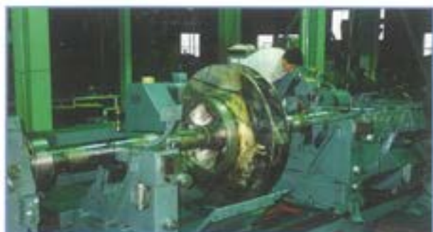
水力発電所向ポンプインペイラー 軸受部再生溶射 溶線式フレーム溶射(ステンレス鋼)
