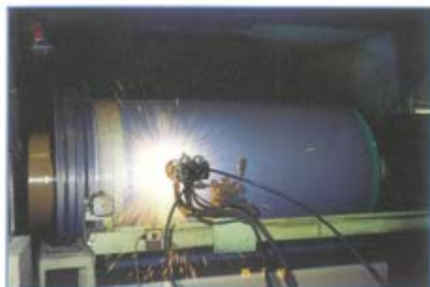
油圧シリンダー摺動面の摩耗部へ再生溶射 溶線式フレーム溶射(ステンレス鋼)
