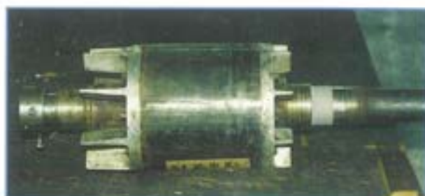
モーター軸再生溶射 溶線式フレーム溶射(ステンレス鋼)
