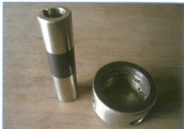
スリーブ プラズマセラミック溶射
