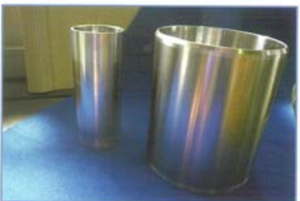
ポンプスリーブ 粉末式フレイム溶射(耐食・耐摩耗)
