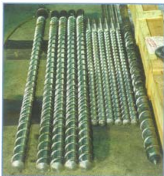
押出成型用・射出成型用スクリー再生溶射 粉末式フレイム溶射(耐摩耗)
