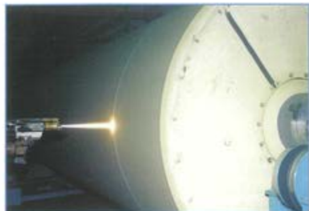
製紙機械用ワインダーロール(φ1500×6000L) HVOFサーメット溶射(耐摩耗)
